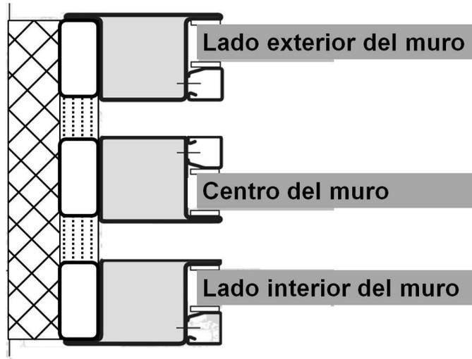
4) Instalación del vidrio: *Vertical u Horizontal / En el Interior o en el Exterior*
